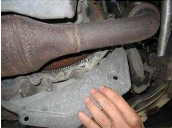
Et puis comme il va falloir lever le moteur pour extraire le carter, on desserre l'écrou du support :
