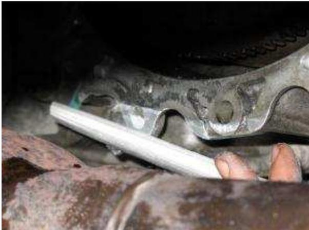
Et on gagne les 2 mm manquants grâce à une bonne lime Bahco (suédoise elle aussi)
