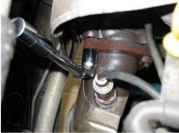
On aperçoit la sonde lambda, qu'on peut être tenté d'enlever pour plus d'accessibilité, mais qu'on peut avantageusement se contenter de débrancher près du réservoir de liquide de frein, c'est plus rapide et ça donne suffisamment de mou dans le câble pour libérer le catalyseur et être à l'aise par la suite :
