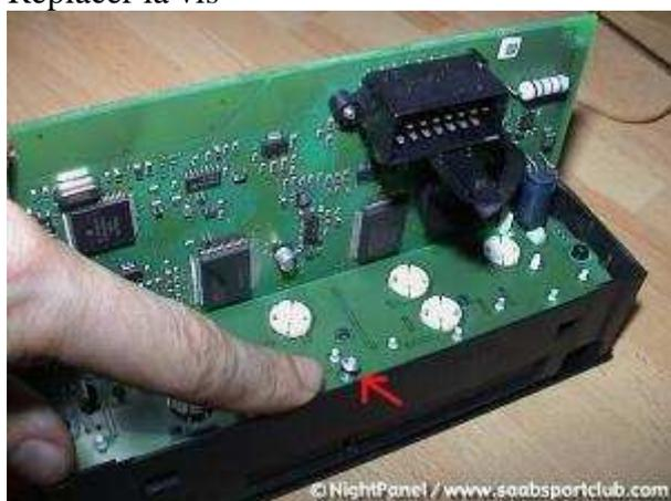
Enclipser délicatement la partie AR du bloc en faisant attention à faire coulisser la platine horizontalement dans le rail de cette coque arrière
