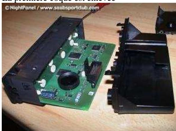
Dévisser la vis de la platine pour retirer l'ensemble plaque verte du boîtier
