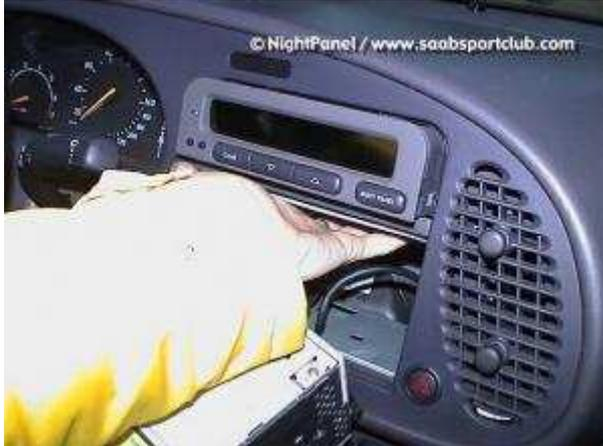
Débrancher le connecteur SID (petit clip à pousser sur le connecteur)
